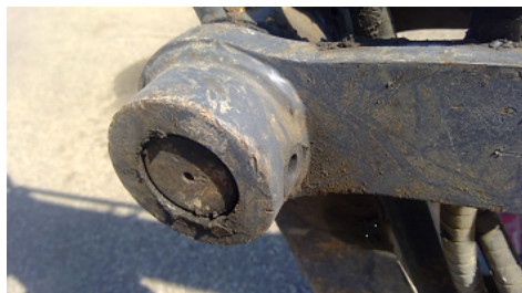
Observation 0302 : ARRET D AXE MANQUANT SUR ARTICULATION ACCESSOIRE
