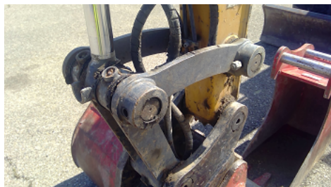
Observation 0302 : ARRET D AXE MANQUANT SUR ARTICULATION ACCESSOIRE
