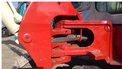
Observation 0302 : Défaut d'aspect FLECTE DEPORTE BLOQUE AVEC CALES SOUDEES AU CHASSIS FISSURES
