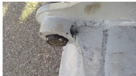
Observation 0302 : ARRETAJE MANQUANT SUR GODET
