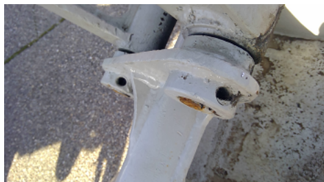
Observation 0302 : ARRETS D AXES MANQUANT SUR FIXATION GODET
