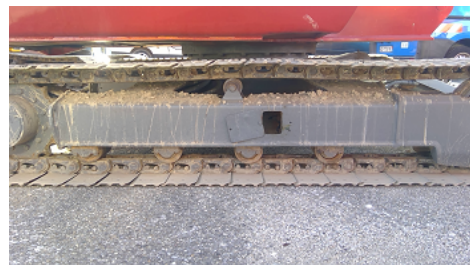
Observation 0202 : MANQUE 1 GALET DE CHENILLES COTE DROIT ET COTE GAUCHE
