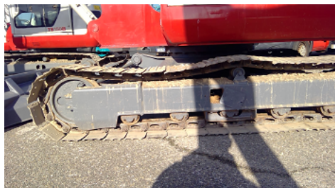
Observation 0202 : Défaut de tension des chenilles
