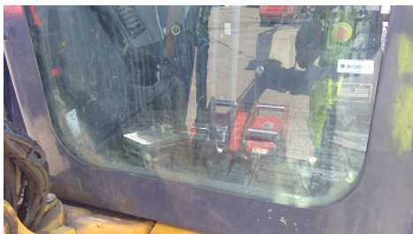
Observation 0604 : MAUVAISE FIXATION DU VITRAGE BAS DU PAREBRISSE MANQUE JOINT SUR L ENSEMBLE PARE BRISE
