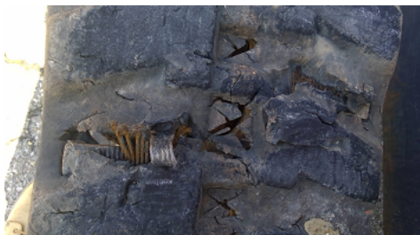
Observation 0202 : Détérioration des chenilles
