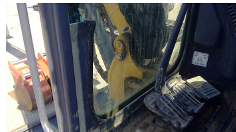
Observation 0604 : MAUVAISE FIXATION DU VITRAGE BAS DU PAREBRISSE MANQUE JOINT SUR L ENSEMBLE PARE BRISE
