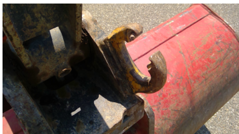
Observation 0804 : Dépose du linguet du crochet
