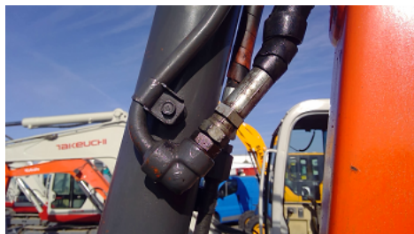
Observation 0903 : FUIITE SUR RACCORD DURITE RIGIDE SUR VERIN D ACCESSOIRE
