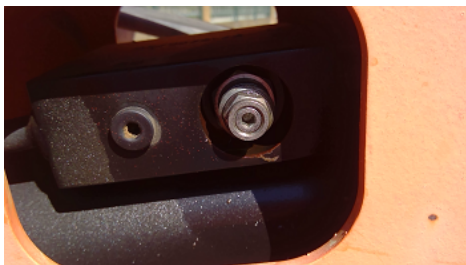
Observation 1103 : Fuite au niveau du clapet du vérin d'inclinaison panier
