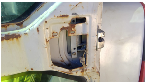
Observation 0101 : Poignée d'accès au poste de conduite détériorée
