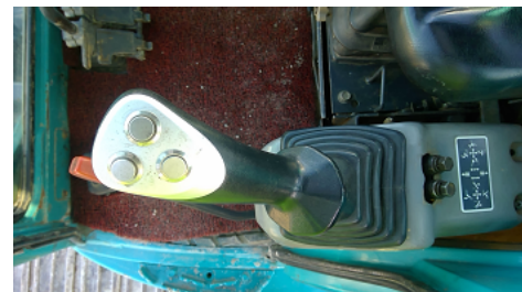
Observation 0701 : COMMANDES INVERSEES SUR JOYSTICK COTE GAUCHE (ROTATION TOURELLE / BALANCIER)
