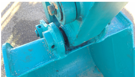
Observation 1101 : ARRETS D AXES MANQUANTS SUR FIXATION GODET
