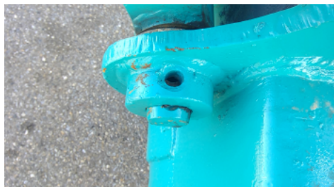
Observation 1101 : ARRETS D AXES MANQUANTS SUR FIXATION GODET
