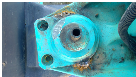
Observation 1004 : Détérioration du dispositif de blocage des éléments mobiles en position route
