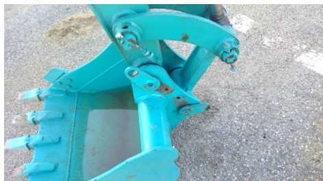
Observation 1102 : PLUSIEURS ARRETS D'AXES MANQUANT SUR FIXATION GODET
