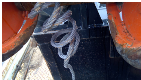
Observation 0401 : Le câble acier présente de nombreuses ruptures de fils
